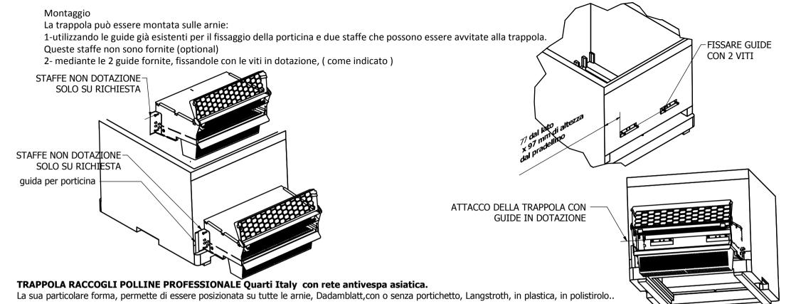
Tre diverse soluzioni di montaggio, utilizzando le guide per il fissaggio della porticina metallica di ingresso, oppure frontalmente all'arnia, montando due apposite guide, oppure su fondi mobili in plastica mediante delle speciali guide ( incluse nel kit fondo mobile e trappola Professional Polline)
