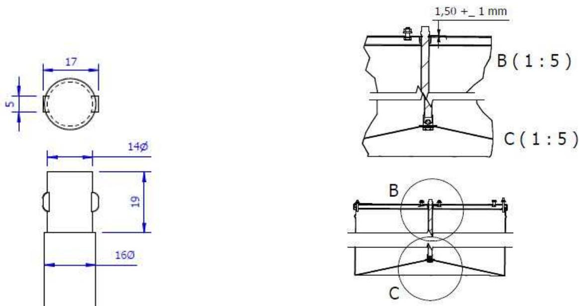
– **Foto2** caratteristiche tecniche necessarie dell'albero , per il montaggio corretto del motore sullo smielatore
