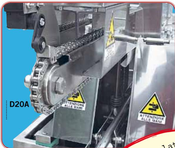
Barrières de protection des mains avec système d'arrêt du cycle
