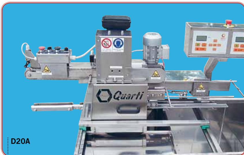
Machine à désoperculer code D20A montée sur extracteur série 2008/45 - avec déchargeur automatique de cadres et accumulateur de cadres désoperculés.
